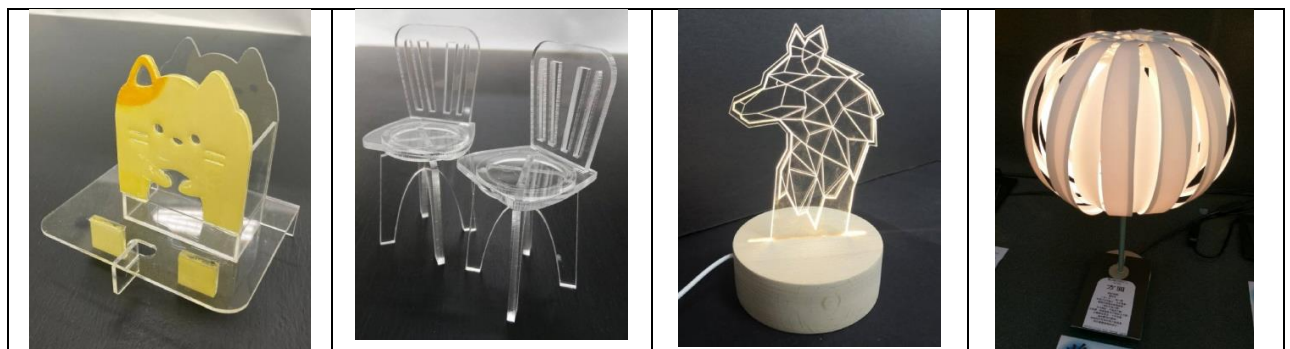
圖 10：雷射切割機進行 PP 板以及壓克力製作 3D 立體設計成品
